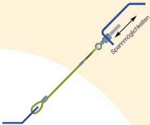
Abhängung mit Spanmöglichkeiten (in einzelner und doppelter Ausführung vorhanden)
