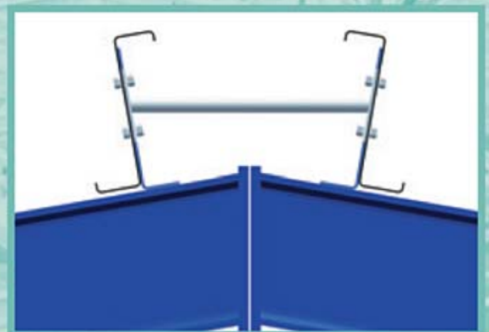
Bolzenfirstzugstange: Standardfirstzugstange für Profilhöhe größer als 250 mm.
