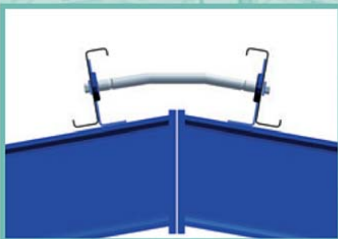
SadeF Lock® Firstzugstange: Standardfirstzugstange für Profilhöhe bis zu 250 mm.
