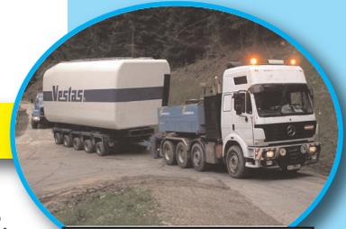
Die Gondel wird mit einem Sattelschlepper angeliefert.
